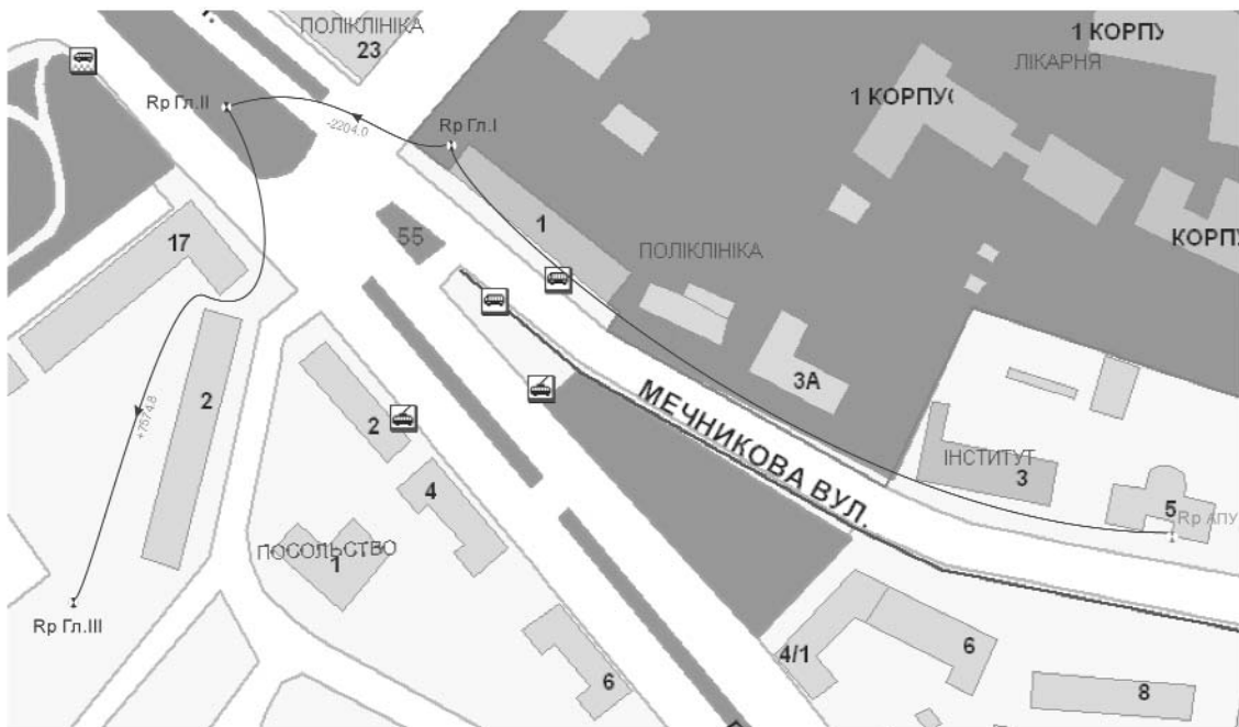
Рисунок 1. Схема нівелювання геодезичної висотної основи
