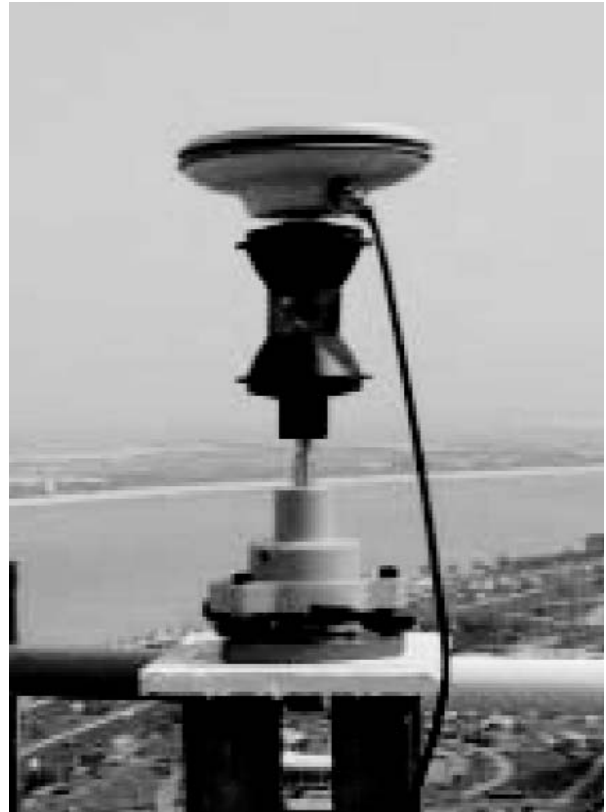
Рисунок 6. Поєднання супутникової антени з призми-відбивачами 360°
